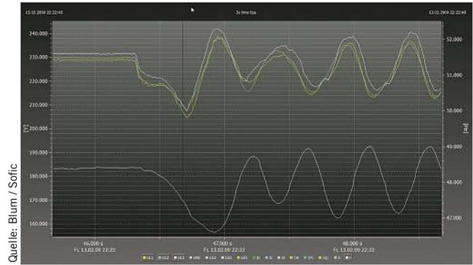
**Bild 8:** Umschaltung einer USV-Anlage vom Netz auf eine NEA in einem Rechenzentrum
