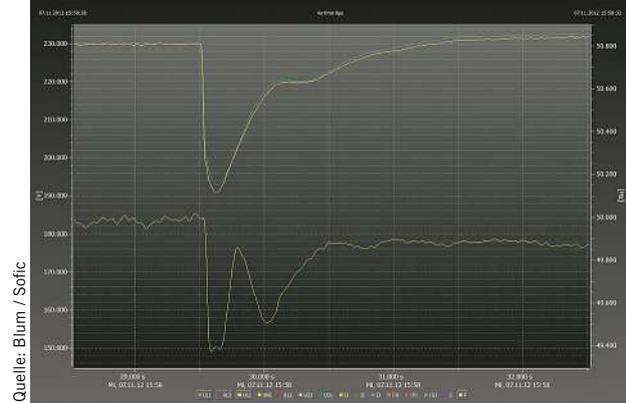
**Bild 4:** Stern-Anlauf der 75-kW-Sprinkleranlage im Notstrombetrieb (ein 500kVA-Notstromdieselaggregat)
