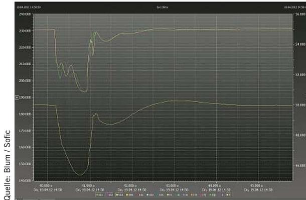
**Bild 2:** Aufschalten von 60 % (ohmsch-induktiv  $\cos \varphi = 0,8$ ) der Bemessungsscheinleistung des 500 kVA-Notstromdieselaggregates bei der Werksabnahme
